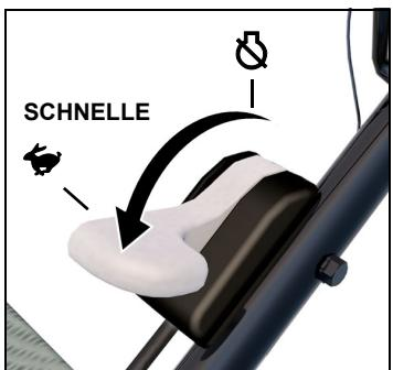
**Die voreingestellte SCHAFFEN Motordrehzahl sollte nicht noch weiter erhöht werden, denn das Schneidwerkzeug könnte dadurch brechen und sich lösen.**
