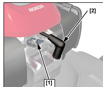
3. Controllare la candela. Sostituire se gli elettrodi sono usurati, o se l'isolatore è incrinato o scheggiato.
