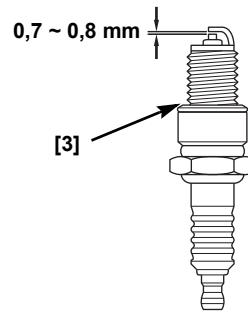
4. Mida con un calibrador adecuado la separación de los electrodos de la bujía. La separación debe ser de 0,7 ~ 0,8 mm. Para corregir la separación de los electrodos de la bujía si fuera necesario, doble cuidadosamente el electrodo lateral.
