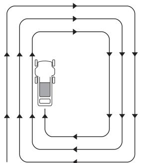
MÄHRICHTUNG BEI VERWENDUNG DES GRASFANGEINRICHTUNGS BZW.
