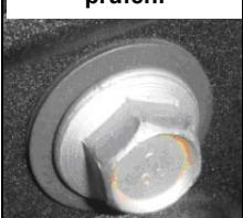
Verwenden Sie nur Honda Original Klingenschrauben und Spezialscheiben, da diese speziell für diesen Zweck entwickelt wurden. Ersatzteilnummern finden Sie auf Seite 19.
