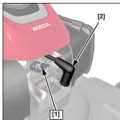
3. Die Zündkerze überprüfen. Wenn die Elektroden abgenutzt sind oder der Isolator Sprünge oder andere Beschädigungen aufweist, die Zündkerze auswechseln. Die Zündkerze mit einer Drahtbürste reinigen, wenn sie wiederverwendet wird.
