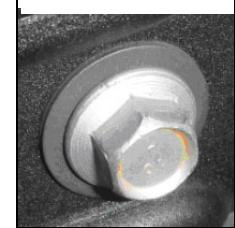
Se appaiono allentati, è necessario utilizzare una chiave dinamometrica per serrare accuratamente i bulloni della lama alla coppia richiesta. Se non si dispone di una chiave dinamometrica, portare il rasaerba a un rivenditore autorizzato per far sostituire o serrare i bulloni.
