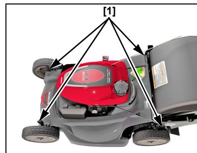
Zur Einstellung der Schnitthöhe jeden Einstellhebel [1] zum Rad ziehen und in einer anderen Einkerbung einrasten lassen.
