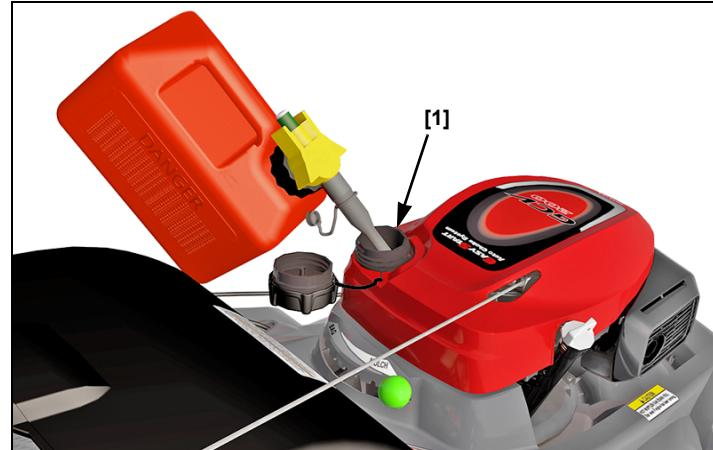
Después de recargar el combustible, apriete firmemente el tapón del tanque de combustible.
