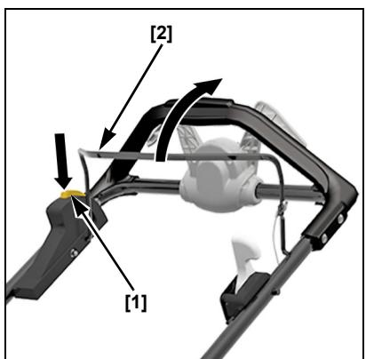
Continuare a tenere la leva di comando dell'organo di taglio contro lo sterzo allo scopo di mantenere la rotazione dell'organo di taglio.
