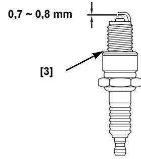
4. Den Elektrodenabstand mit einer geeigneten Lehre messen. Der Abstand sollte 0,7 ~ 0,8 mm betragen. Den Elektrodenabstand im Bedarfsfall durch vorsichtiges Verbiegen der Außenelektrode nachstellen.
