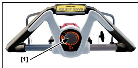
En una operación normal, usted coloca las manos con comodidad alrededor del manillar y del control Select Drive. Empuje el control Select Drive con el pulgar dentro de la indentación para generar mayor potencia (para subir una colina o avanzar a través de césped grueso).
