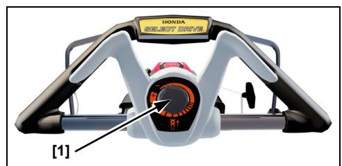
En exploitation normale, une main tient confortablement le guidon et la commande Select Drive. Au moyen du pouce, pousser la commande Select Drive d'un cran pour accélérer le fonctionnement (montée d'une pente, ou herbe dense).
