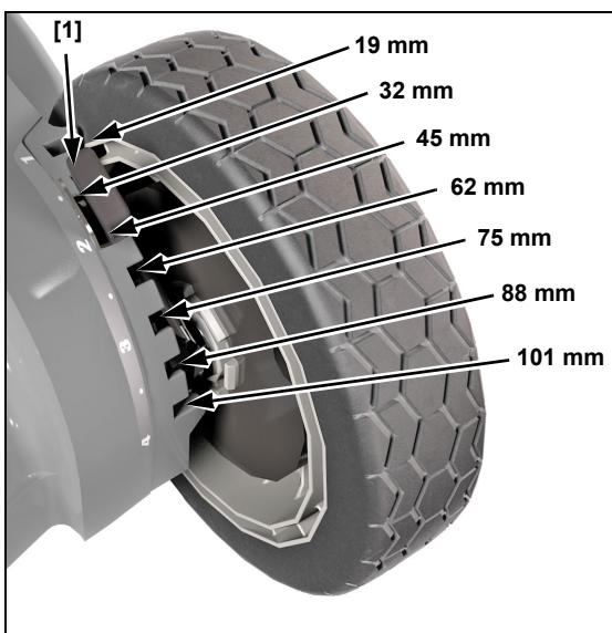
l'aspetto del prato dopo aver tosato un piccolo spazio. Modificare la regolazione dell'altezza di tosatura se necessario.
