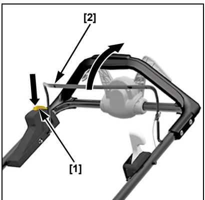
Houd de bedieningshendel van het snijmiddel tegen de stuurstang om de rotatie van het snijmiddel te behouden. Houd de bedieningshendel van het snijmiddel altijd volledig ingeschakeld tijdens het maaien. Laat nooit gedeeltelijk los - dit zal de levensduur van de koppeling verminderen.
