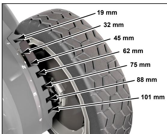
Vi è una levetta [1] di regolazione per ogni ruota.
