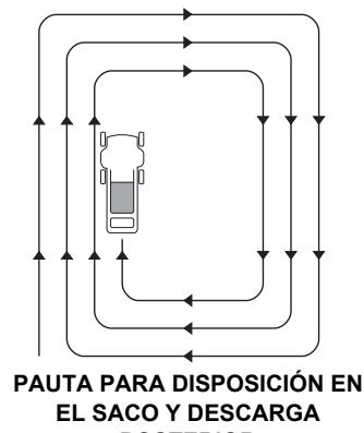
**Cortado de césped con descarga posterior**
