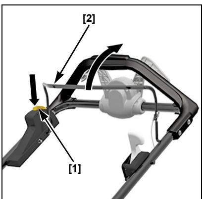
Siga manteniendo la palanca de control del medio de corte hacia el manillar para que el medio de corte siga girando. Mientras se corta el césped, mantenga siempre la palanca de control del medio de corte totalmente engranada. No la libere parcialmente; hacerlo reducirá la vida útil del sistema de embrague.
