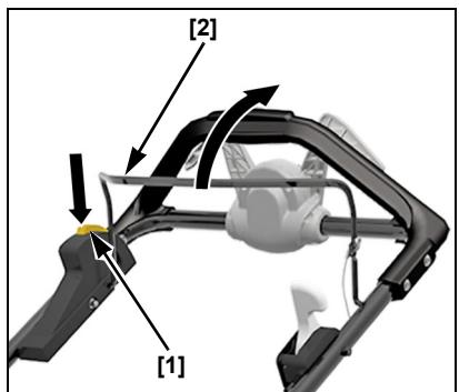
Maintenir le levier de commande de l'organe de coupe serré contre le guidon de façon qu'il ne cesse pas de tourner. Pendant toute la durée de la tonte, le levier de commande de l'organe de coupe doit être maintenu serré. Ne pas relâcher le serrage car cela aurait pour effet de faire patiner l'embrayage et d'en réduire la durée de vie.
