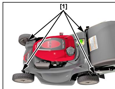
Para ajustar la altura de corte, tire de cada palanca de ajuste [1] en dirección hacia la rueda, y muévala hasta otra muesca.
