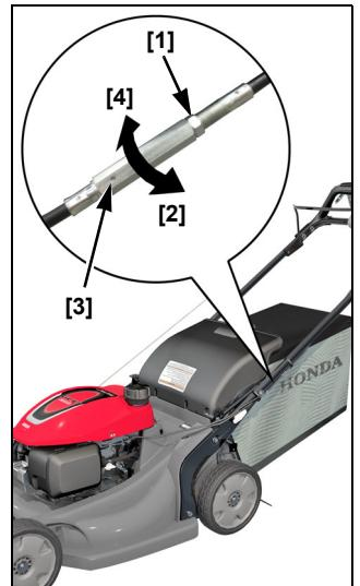
Start de motor om zeker te zijn dat de grasmaaier niet vooruit beweegt zonder dat de bediening Select Drive wordt ingeduwd.
