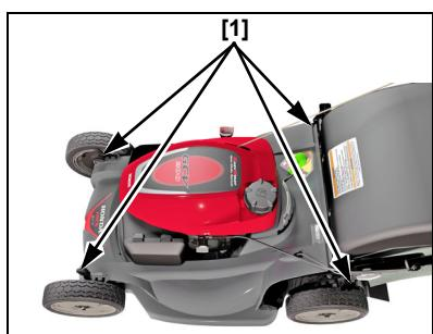
Afin de régler la hauteur de tonte, tirez chaque levier de réglage [1] vers la roue et bloquez-le sur le cran désiré.
