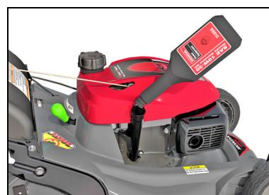
5. Después de cambiar el aceite del motor, y antes de encender el motor, verifique el nivel de aceite cuando el cortacéspedes se encuentre sobre una superficie a nivel:
