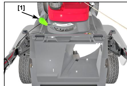
La descarga posterior máxima ocurrirá cuando la perilla del director de corte se encuentre completamente hacia la posición izquierda (BAG [saco]). Al moverse la perilla del director de corte hacia la posición derecha (MULCH [trituración]), menos hierba será descargada a través del protector de descarga posterior.
