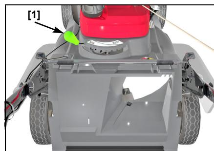
Une décharge arrière maximum se produit lorsque le bouton de commande de tonte se trouve totalement à gauche en position (SAC). Au fur et à mesure que le bouton de commande de tonte est déplacé vers la position droite (BROYAGE), moins de gazon est déchargé par la protection de décharge arrière.
