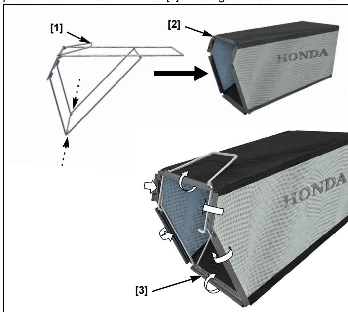
Heben Sie den Auswurfdeckel [4] an, und bringen Sie den Grasfangeinrichtung an.
