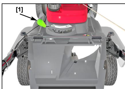
Maximale afvoer naar achteren vindt plaats als de maaiselrichterknop in de stand (BAG) helemaal links staat. Door de maaiselrichterknop meer naar rechts (MULCH) te schuiven, wordt er minder gras afgevoerd door de afvoerbeschermkap achter.
