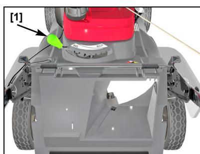
Spostando la manopola completamente verso sinistra nella posizione di raccolta (BAG), si otterrà il massimo scarico posteriore. Spostando la manopola verso destra nella posizione di sminuzzatura (MULCH), una minore quantità di erba verrà scaricata attraverso il parasassi posteriore.
