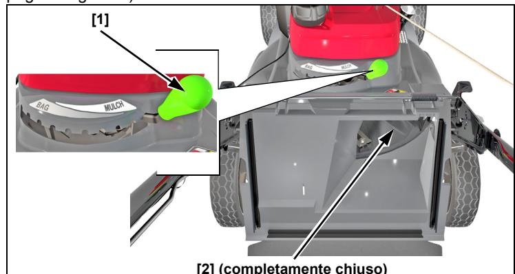
Se si incontra una notevole resistenza nel corso della regolazione della manopola da una posizione all'altra, significa che una quantità eccessiva di erba potrebbe essersi accumulata sulla parte superiore dello sportello scorrevole.
