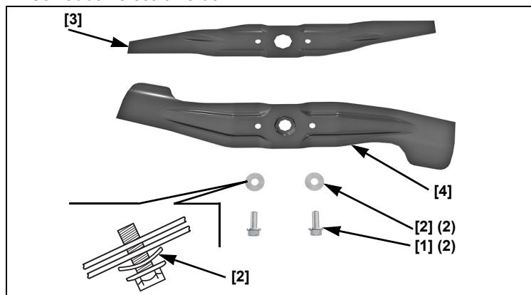
3. Die Befestigungsschrauben der Schneidwerkzeug [3][4] mit einem Drehmomentschlüssel [7] festziehen. Die Schneidwerkzeug mit einem Holzklotz blockieren [6], damit sie sich nicht drehen können.
