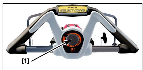
Si può ridurre la velocità di avanzamento sbloccando parzialmente il comando Select Drive.
