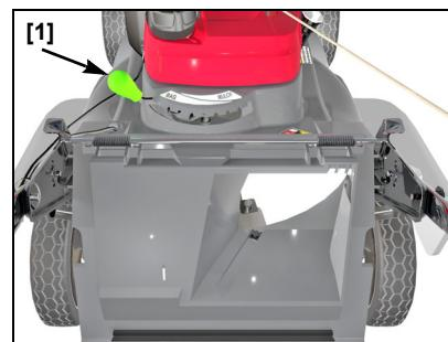
Ein maximaler Auswurf an der Hinterseite wird gewährleistet, wenn der Schnittrichtungsknopf ganz nach links in die Position BAG (SACK) gestellt wird. Je weiter der Schnittrichtungsknopf nach rechts (MULCH) bewegt wird, desto weniger Gras wird durch den hinteren Auswurfdeckel ausgeworfen.
