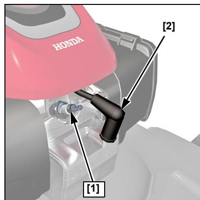
3. Inspeccione la bujía. Cámbiela si los electrodos están gastados o si el aislante está fisurado o astillado. Limpie la bujía con un cepillo de cerdas de alambre si desea utilizarla nuevamente.
