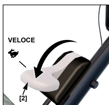
4. Per impedire alle lame di girare e per prevenire un movimento in avanti del tosaerba, disinserire sempre la leva di comando della lama e la leva di innesto della trasmissione quando si usa l'avviatore.
