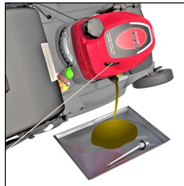
Favor de desechar el aceite usado del motor y los recipientes en una forma que sea compatible con las medidas de protección del medio ambiente. Le sugerimos además que lleve el aceite usado, en un recipiente sellado, hasta el centro local de reciclado o a una estación de servicio para el reciclado. No deseche el aceite usado junto con la basura, no lo vierta sobre el suelo ni a través de las tuberías de drenaje.
